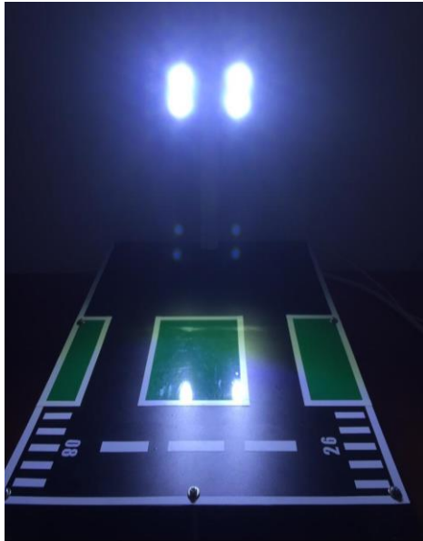
(b) Gambar 19 (a) Setelah Option ditekan (b) kondisi semua lampu floodlight dalam keadaan ON
