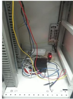
Gambar 3. Hasil Rangkaian Pendeteksi Arus dan Tegangan Pada RGL
