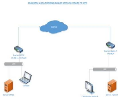
Kemudian setelah melakukan dua tahapan tersebut maka penulis dan teknisi mengambil tindakan *Setting Router MikroTik JATSC* dan *Setting Router MikroTik AirNav Cabang Halim Perdanakusuma*. Hal ini dilakukan agar pengiriman radar tidak melalui *converter* lagi yaitu dengan dengan protokol IP to IP menggunakan Routerboard MikroTik dengan memanfaatkan jaringan internet (ASTINET) yang telah tersedia.
