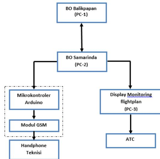
Gambar 2. Blok diagram perancangan
