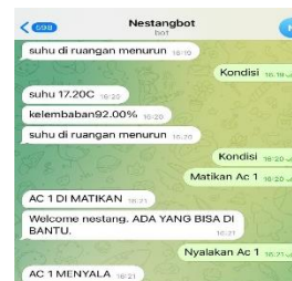
Gambar 4. 3 Kontrol dan Monitoring ruangan saat mengalami penurunan suhu
