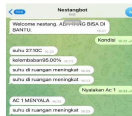
Gambar 4. 2 Kontrol dan Monitoring ruangan saat mengalami kenaikan suhu
