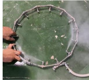
Alat *fuel nozzle tester engine PT6A* menggunakan media bantu *pneumatic* ini lebih efektif dibandingkan alat sebelumnya karena alat ini menguji *Fuel nozzle* secara 14 *nozzle* sekaligus dan pada alat sebelumnya hanya bisa menguji *Nozzle* satu persatu.
