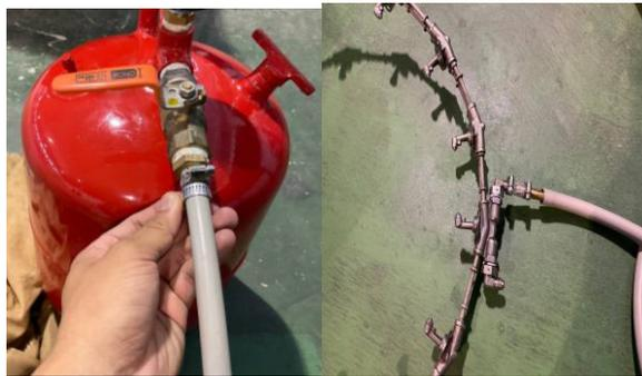
Gambar 6. Pengujian *Fuel nozzle Tester* Menggunakan Pneumatic
