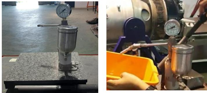
Gambar 1. Kondisi Saat Ini *Fuel Nozzle Tester* Menggunakan *Jacking*
