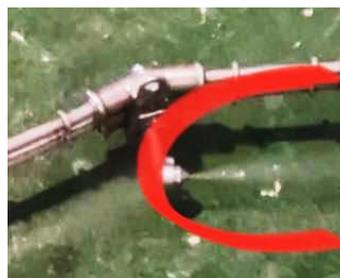
Pada saat pengujian, *fuel nozzle 8* terlihat melakukan *vaporizing* dengan kurang cepat dan hasil *spray* berbentuk *intermediate pressure* serta masih kondisi *acceptable* dan dapat kita ketahui bahwa *fuel nozzle 8* ini merupakan *secondary fuel nozzle*.
