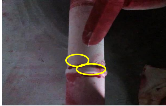
Gambar 5. Indikasi Linear Pada Axle Main Landing Gear Cessna 152
