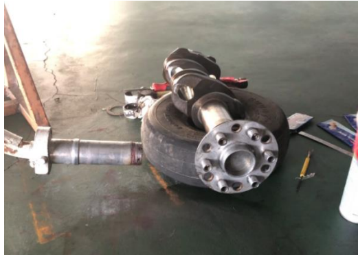
Gambar 3. Axle Main Landing Gear dan Propeller Hub Cessna 152 Sebelum Dilakukan Pengujian Liquid Penetrant Testing
