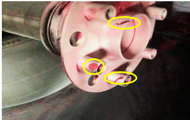
Gambar 6. Indikasi Linear dan Indikasi Rounded Propeller Hub Cessna 152
