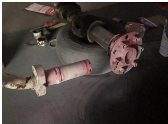
Gambar 4. Axle Main Landing Gear dan Propeller Hub Cessna 152 Setelah Dilakukan Pengujian Liquid Penetrant Testing
