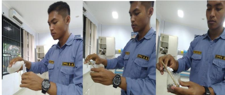
Gambar 4. Proses Pencampuran Resin dan Katalis
