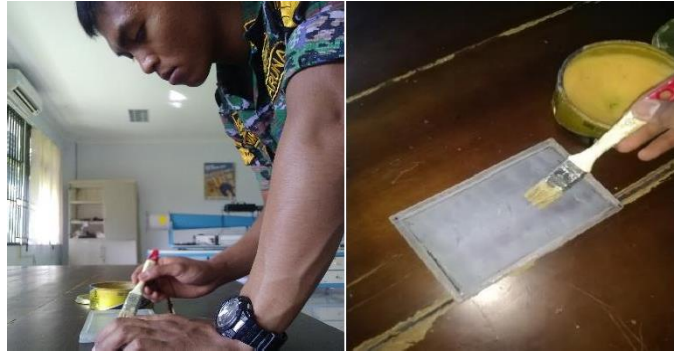
Gambar 3. Pengolesan Maximum Mold Release Wax ke Cetakan
