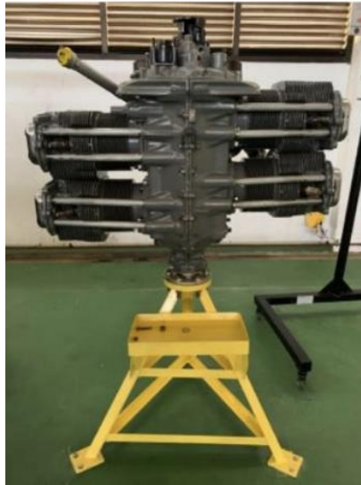
Gambar 4. Hasil Reassembly Menggunakan Alat Teardown Reciprocating Engine
